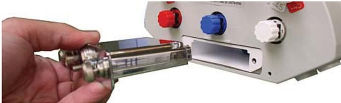
Le module doit entrer librement. S'il est dur à insérer, ne pas forcer mais essayer dans l'autre sens. Lorsque le module arrive presque au fond, appliquer une poussée un peu plus forte pour l'engager dans le connecteur.
